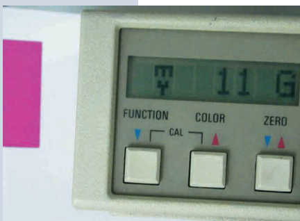
Figura 2: Lectura de densitómetro de un grado de gris de 11%
